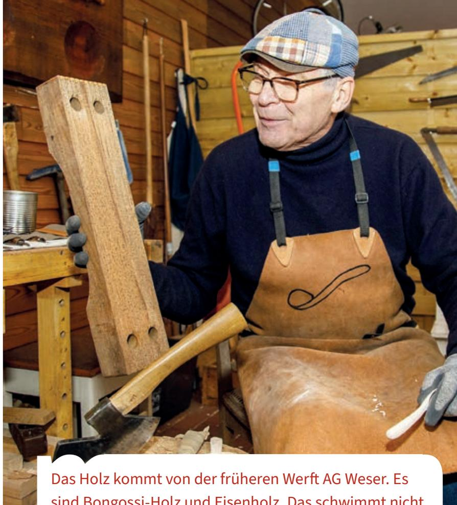
Das Holz kommt von der früheren Werft AG Weser. Es sind Bongossi-Holz und Eisenholz. Das schwimmt nicht im Wasser. Schiffe wurden darauf gelagert, es dient also zum Stapeln. Das Holz ist sehr fettig.
